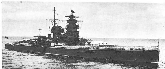
El "Almirante Szeher", uno de los tres acorazados de bolsillo de Alemania, que deben ser clasificados como cruceros acorazados. Monta 6 piezas de 11 pulgadas en dos torrecillas triples, y desarrolla 29 nudos. Con más andar que los acorazados y mejor armamento y protección que los cruceros, estos buques alemanes sólo pueden ser atacados por el "Hood", el gran crucero de batalla inglés.
